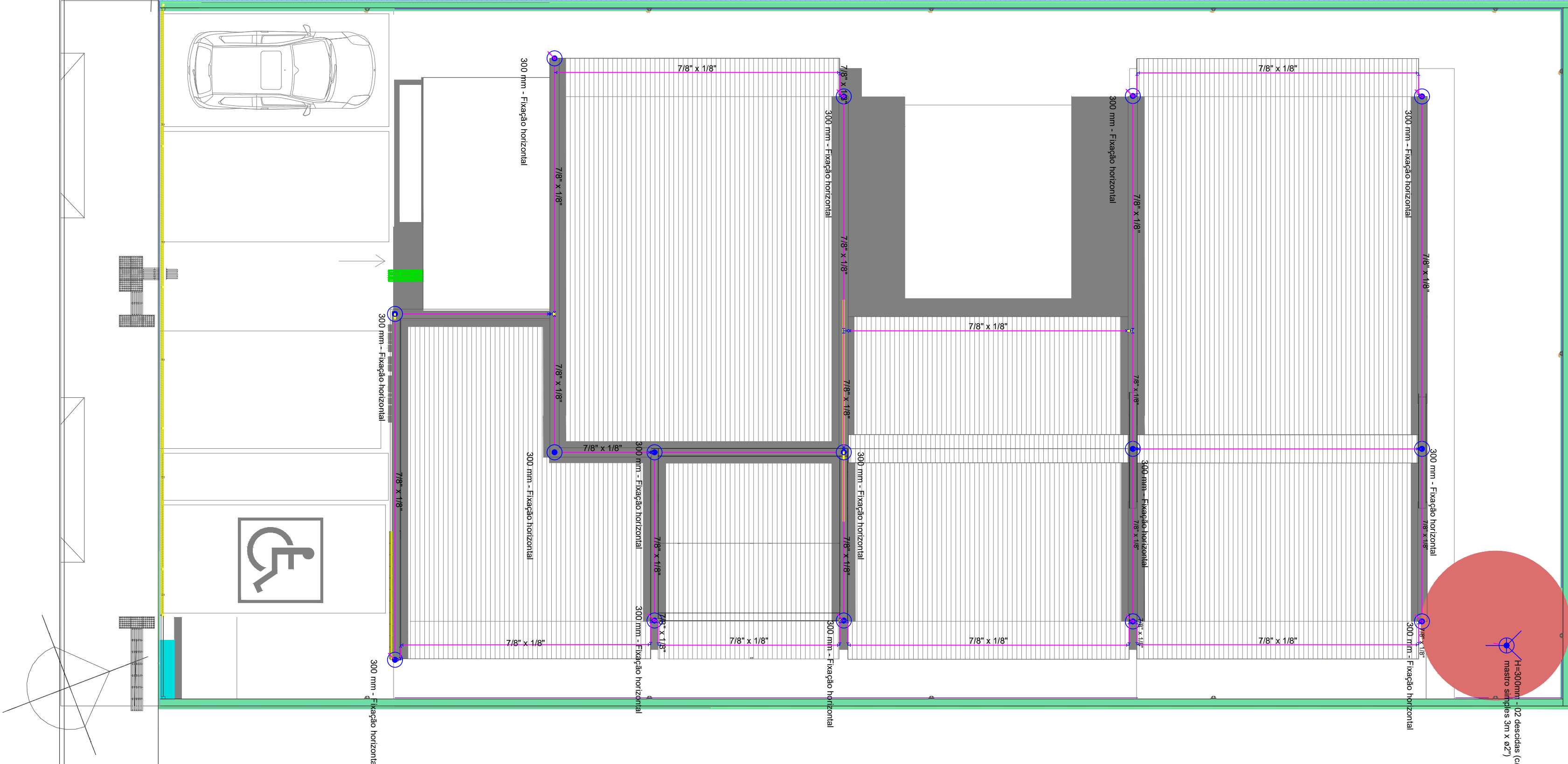
PLANTA COBERTURA - MALHA DE CAPTAÇÃO Escala 1:50
